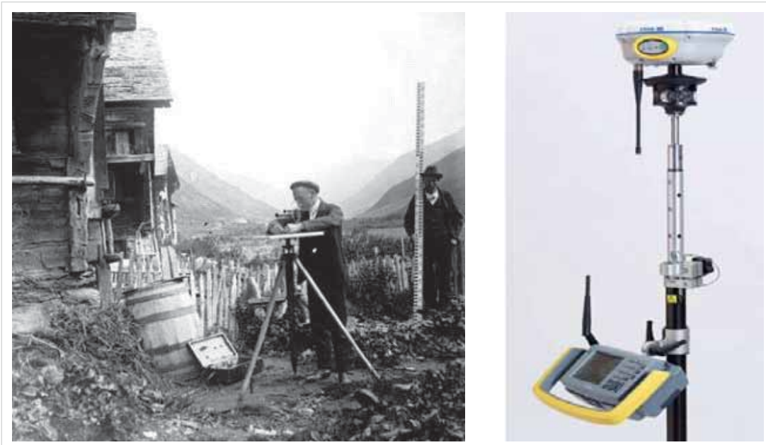
Abbildung 2: Vermessung gestern und heute: Tachymeter – GPS-Empfänger. Bildnachweis: (links) Bundesamt für Landestopografie, Bern, Martin Gurtner; (rechts) Firma Trimble.
